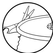
Des fibres lâches peuvent être un signe d'usure du tissu en microfibres. **NE PAS** tirer sur les fibres lâches. Cela risque de défaire le tissage. Couper simplement les fibres lâches avec des ciseaux.
