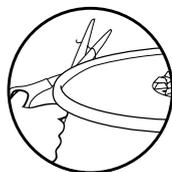
Losse vezels kunnen een aanwijzing zijn dat de microvezelstof aan het slijten is. Trek **NIET** aan de losse vezels om te voorkomen dat het weefsel beschadigt. Knip losse vezels met een schaar af.
