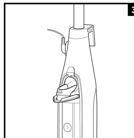
3 Tirer le couvercle du réservoir d'eau vers le bas pour l'ouvrir.
