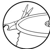
Lose Fasern weisen möglicherweise auf den Verschleiß des Mikrofasermaterials hin. **NIEMALS** an losen Fasern ziehen, da dies das Gewebe beschädigen kann. Schneiden Sie lose Fasern einfach mit einer Schere ab.
