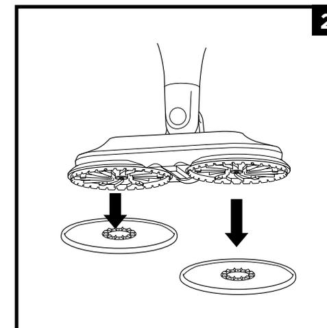
2 Pour fixer les lingettes Dirt Grip, positionner **LES DEUX** lingettes à plat sur le sol avec les anneaux en plastique orientés vers le haut. Aligner l'encoche des disques rotatifs situés sous la buse avec les anneaux en plastique des lingettes, puis abaisser doucement la buse sur les lingettes en appuyant jusqu'à ce qu'elles soient fixées.
