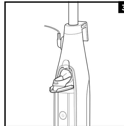
3 Trekk lokket på vannbeholderen ned for å åpne.
