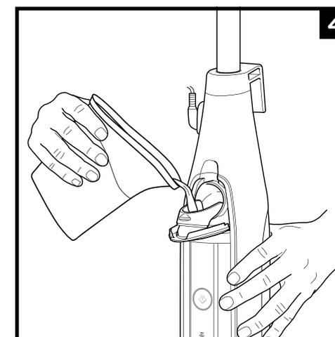
4 À l'aide du flacon de remplissage, verser de l'eau distillée dans le réservoir. Veiller à ne pas dépasser la ligne max fill (remplissage max) du flacon. Refermer ensuite correctement le couvercle du réservoir.
