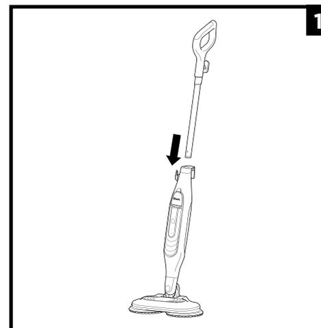
1 Insérer la poignée dans le corps du balai vapeur jusqu'à entendre un déclic.
