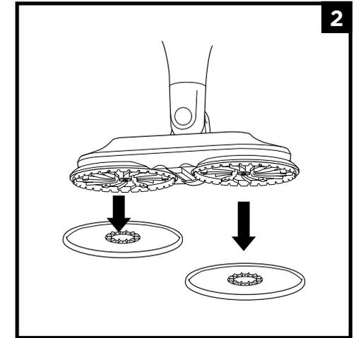
**2** Om de pads te bevestigen legt u **BEIDE** pads met de plastic ringen omhoog plat op de vloer. Plaats de inkeping op de roterende schijven aan de onderkant van de voetkop op dezelfde lijn als de plastic ringen op de pads en laat de voetkop vervolgens voorzichtig op de pads zakken tot de pads druk vast komen te zitten.
