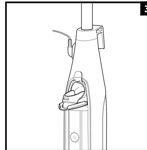
**3** Trek het deksel omlaag om het waterreservoir te openen.
