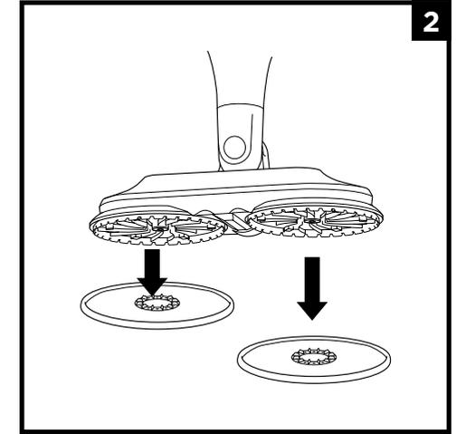
2 Um die Grip Schmutz pads zu befestigen, **BEIDE** Pads flach auf den Boden legen, wobei die Kunststoffringe nach oben zeigen. Die Vertiefung auf den rotierenden Scheiben auf der Unterseite der Düse mit den Kunststoffringen auf den Pads ausrichten, dann die Düse vorsichtig auf die Pads senken und drücken, bis die Pads befestigt sind.
