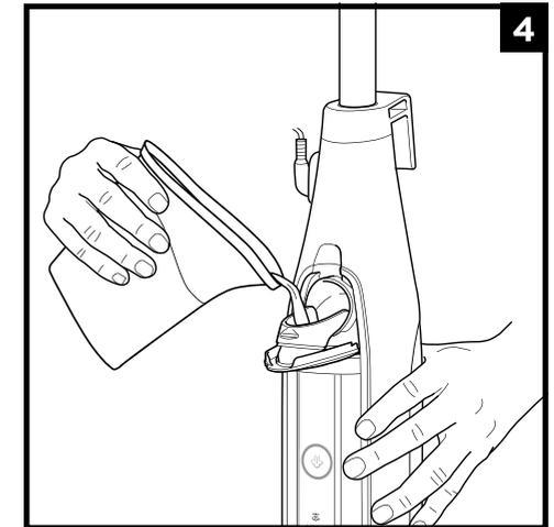
4 Füllen Sie destilliertes Wasser mit Hilfe der Einfüllflasche in den Wasserbehälter. Achten Sie darauf, die Linie „Max. Fill“ auf der Flasche nicht zu überschreiten. Anschließend den Wasserbehälterdeckel fest schließen.
