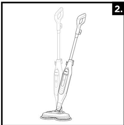
**2** Um mit der Reinigung zu beginnen, setzen Sie Ihren Fuß auf den Bodenkopf und lehnen Sie den Griff zu Ihnen. Dadurch werden die Power Pads eingerastet.
