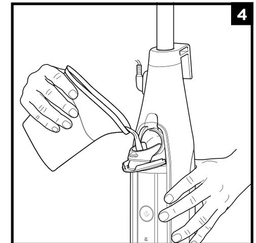
**4** Gebruik de schenkan om het reservoir met water te vullen. Zorg dat u de schenkan niet boven de lijn met het maximale waterniveau vult. Sluit het deksel zorgvuldig nadat u het waterreservoir heeft gevuld.
