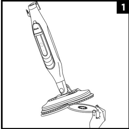
**1** Wenn die Pads vollständig abgekühlt sind, entfernen Sie sie, indem Sie sie von den Scheiben abziehen.
