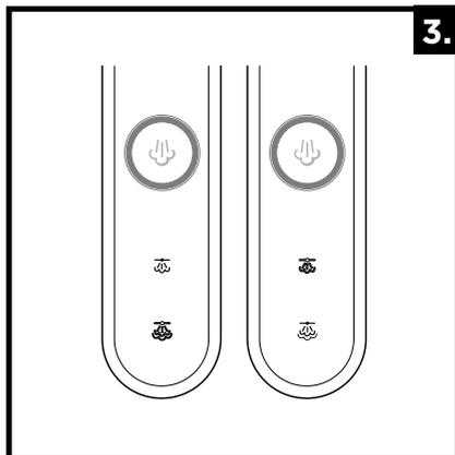
**3** Wanneer de mop voor het eerst op een stopcontact wordt aangesloten is de stand-bymodus geactiveerd en knipperen er twee indicatorlampjes. Selecteer de gewenste instelling met behulp van de modusknop.
