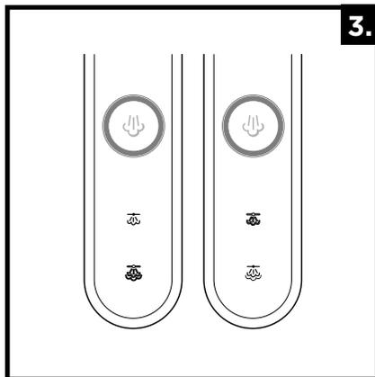
**3** Wenn der Mopp zum ersten Mal eingesteckt wird, befindet sich das Gerät im Standby-Modus und 2 Anzeigelampen blinken. Wählen Sie Ihre bevorzugte Einstellung mit der MODE-Taste aus.
